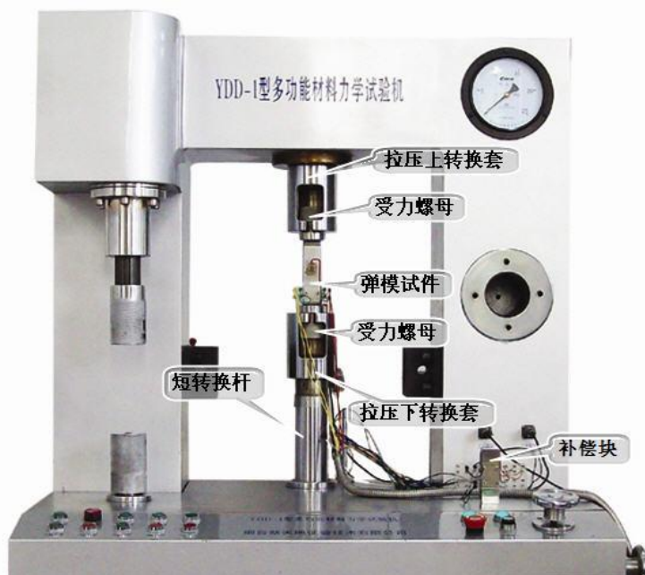
图 4.4 弹模试件的装夹
