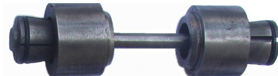
图 1.12 试件装夹示意
