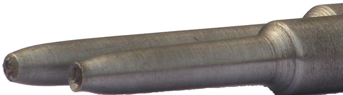
图 1.4 低碳钢 Q235 试件拉伸实验断口形式
