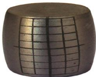
图 2.4 低碳钢 Q235 试件压缩实验变形过程
