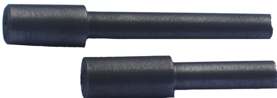
图 1.5 铸铁 HT200 试件拉伸实验断口形式
