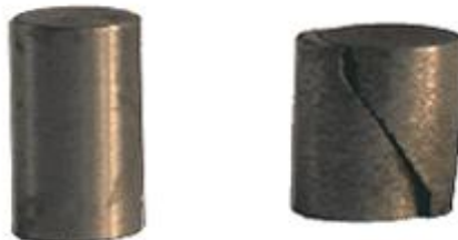
图 2.5 铸铁 HT200 试件压缩实验破坏现象
